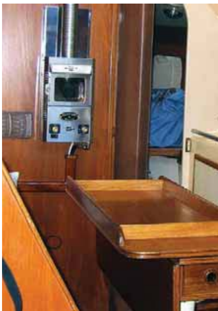
Рис. 4. Газовый переборочный отопитель «Dickinson Newport P12000» в интерьере каюты. Под столиком виден электрический тепловентилятор, который можно дополнительно включать во время стоянки у оборудованного электроснабжением причала. Теплопроизводительность: без вентилятора – 1,08–1,49 кВт/ч, с вентилятором – 2,16–3,1 кВт/ч. От 24-литрового баллона (10 кг) печка будет работать 78 ч на максимальном режиме и 110 ч – в экономичном. Габариты – 213×181×400 мм. Монтажная глубина – 200 мм. Масса – 9,1 кг.
