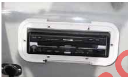
Автомобильный CD-проигрыватель «Panasonic» установлен в защитном боксе со съемной передней крышкой. При наличии пульта дистанционного управления снимать крышку необходимо только при смене дисков.
