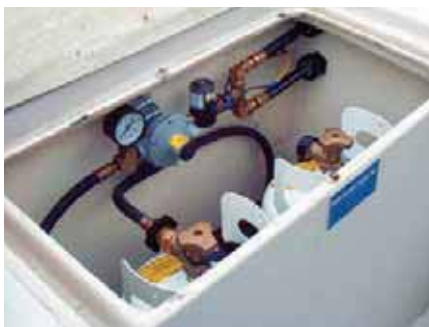
Рис. 9. Самодельный рундук на два газовых баллона. Корпус – из старого морозильного ларя.
