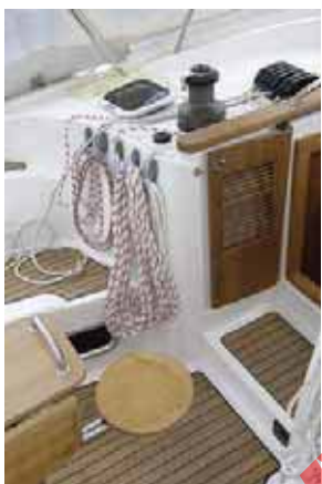
Носовая часть кокпита: фиксирующиеся дверцы сходного люка, аккуратные крючки для фалов, на переднем плане – выдвинутое сиденье
