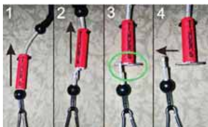
Рис.3. Распространенная система отстрела страховочного лиша 1 – максимально быстро дергаем красную трубку от себя; 2 – освобождается металлический крюк с той стороны лиша, которая ближе к трапеции; 3 – крюк с щелчком раскрывается; 4 – лиш разъединяется
