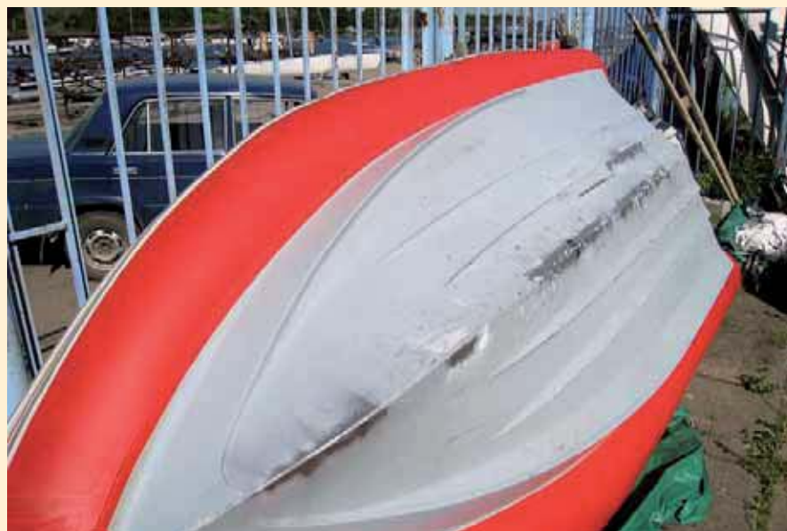
Общий вид лодки перед началом работ. Видны не только сколы, но также «заплатки», ранее сделанные по предлагаемой нами технологии. Они, как можно заметить, выдержали удары лучше, чем родное декоративное покрытие – гелькоут.
