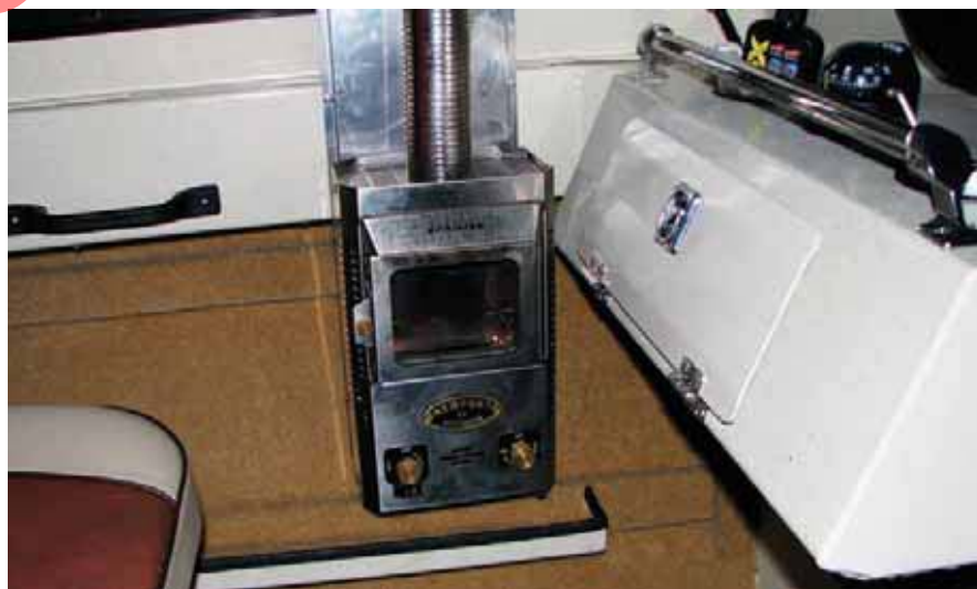
Рис. 3. Газовый отопитель «Dickinson Newport P9000», установленный в салоне катера «Hewes Craft Sea Runner 220», расположен ближе к пайолу в соответствии с рекомендациями. Над бардачком имеется поручень, чтобы в случае качки пассажир мог ухватиться за него, а не за горячий воздуховод. Теплопроизводительность без вентилятора — 0.84–1.17 кВт/ч, с вентилятором — 1.75–2.45 кВт/ч. Расход газа: 24-литрового баллона (10 кг) хватает на 100 ч работы на максимальном режиме и на 140 ч — в экономичном. Габариты — 213×138×350 мм. Монтажная глубина — 163 мм. Масса — 6.82 кг.
