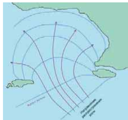
Схема искривления волновых фронтов при проходе пролива между островом слева и мысом справа. «Вливаясь» в залив, волны своими гребнями поворачивают в зоны, закрытые для прямого прохода. При этом высота их уменьшается (но может вырасти при подходе к мелководью), а направление распространения изменяется более чем на 90°.
