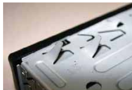
Расположение отгибающихся крепежных уголков рассчитано на разные толщины установочной панели
