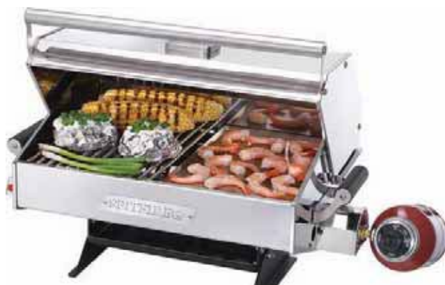
Рис. 7. Портативный газовый гриль «Spitfire 180». Показан с комбинированной рабочей поверхностью (одна из секций – плоский лист). Высококачественная решетка из толстых, тесно расположенных прутьев. Пьезорозжиг. Мощность горелки – 2770 ккал/ч. Площадь рабочей поверхности – 1161 см 2 . Габариты – 61×33×37,5 см. Вес – 10 кг. Поставляется с подставкой из анодированного алюминия.
