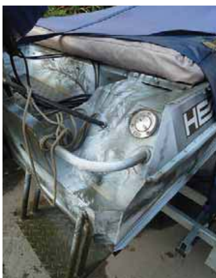
Рис. 6. Транцевые плиты не только облегчили выход на глиссирование, но и могут использоваться как ступеньки
