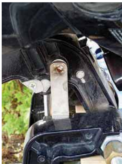
Рис. 8. Для надежности удержания мотора в поднятом положении добавлен дополнительный кронштейн-фиксатор
